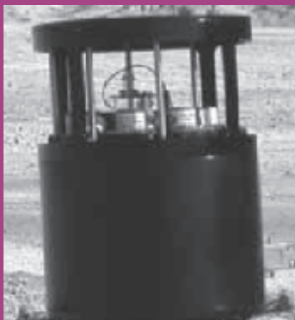
Naso Elettronico ENEA ("NASECANE") dislocato presso il cratere della Solfatara.
